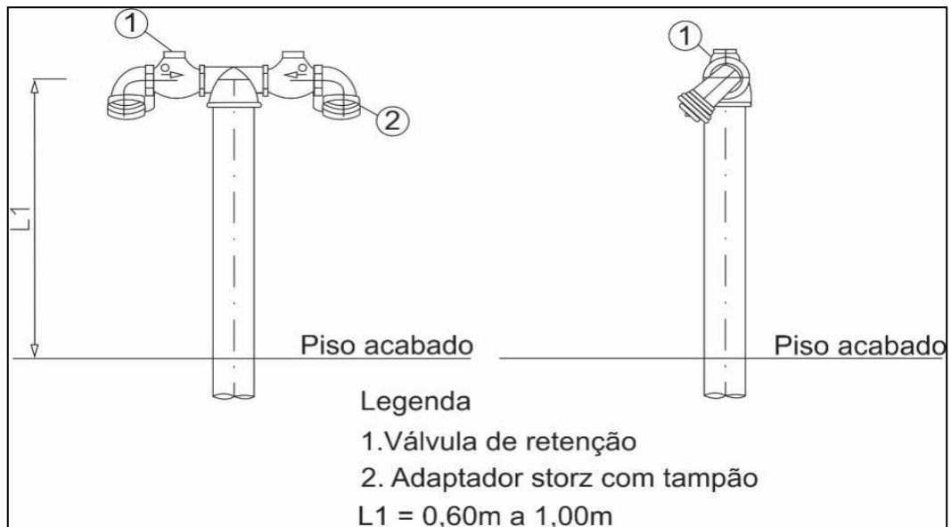
II – DISPOSITIVO DE RECALQUE TIPO COLUNA
