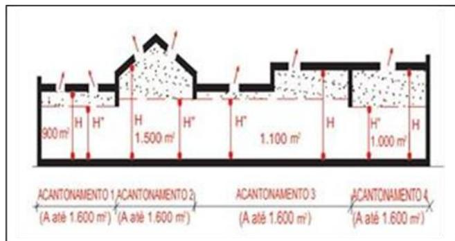
Figura 15: Altura de referência diversificada por acantonamento
