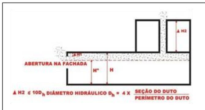
Figura 16: Diâmetro hidráulico
