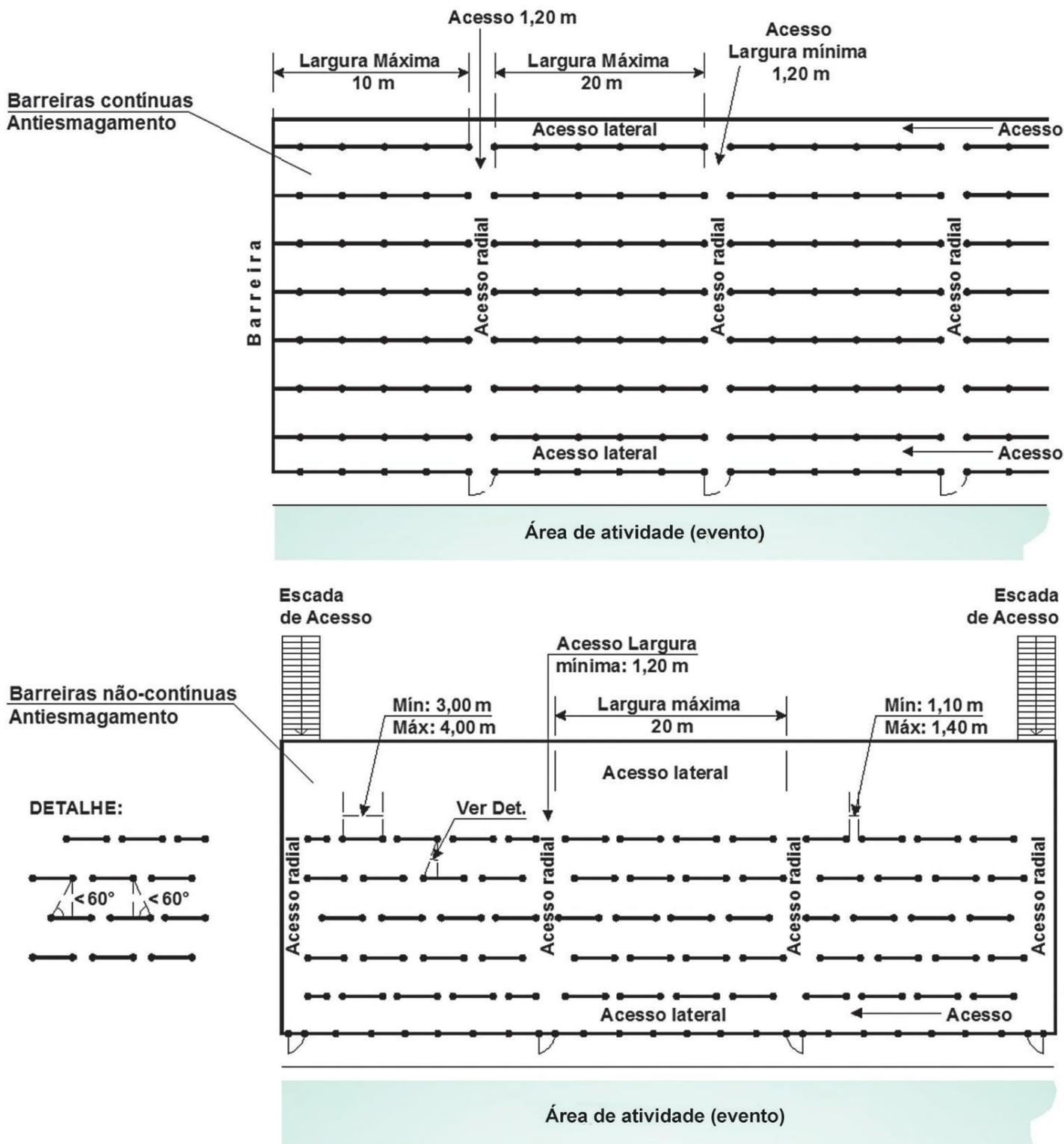
Figura 10: Barreiras antiesmagamento – contínuas e não contínuas - Fonte: CBPMESP e ARENA, com base no “Green Guide”
