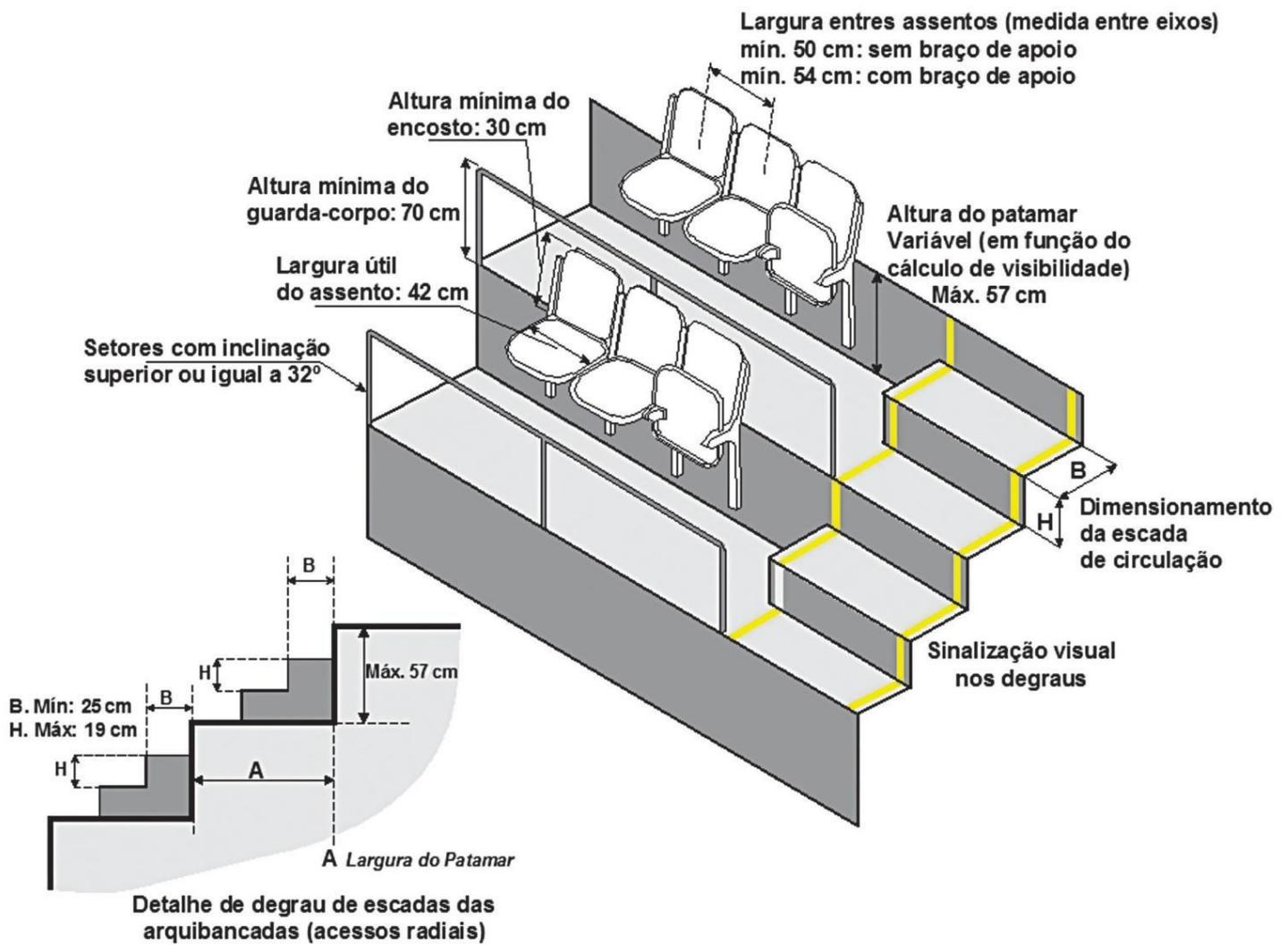
Figura 3: Detalhe das dimensões dos assentos e dos patamares - Fonte: CBPMESP e ARENA, com base no "Green Guide"
