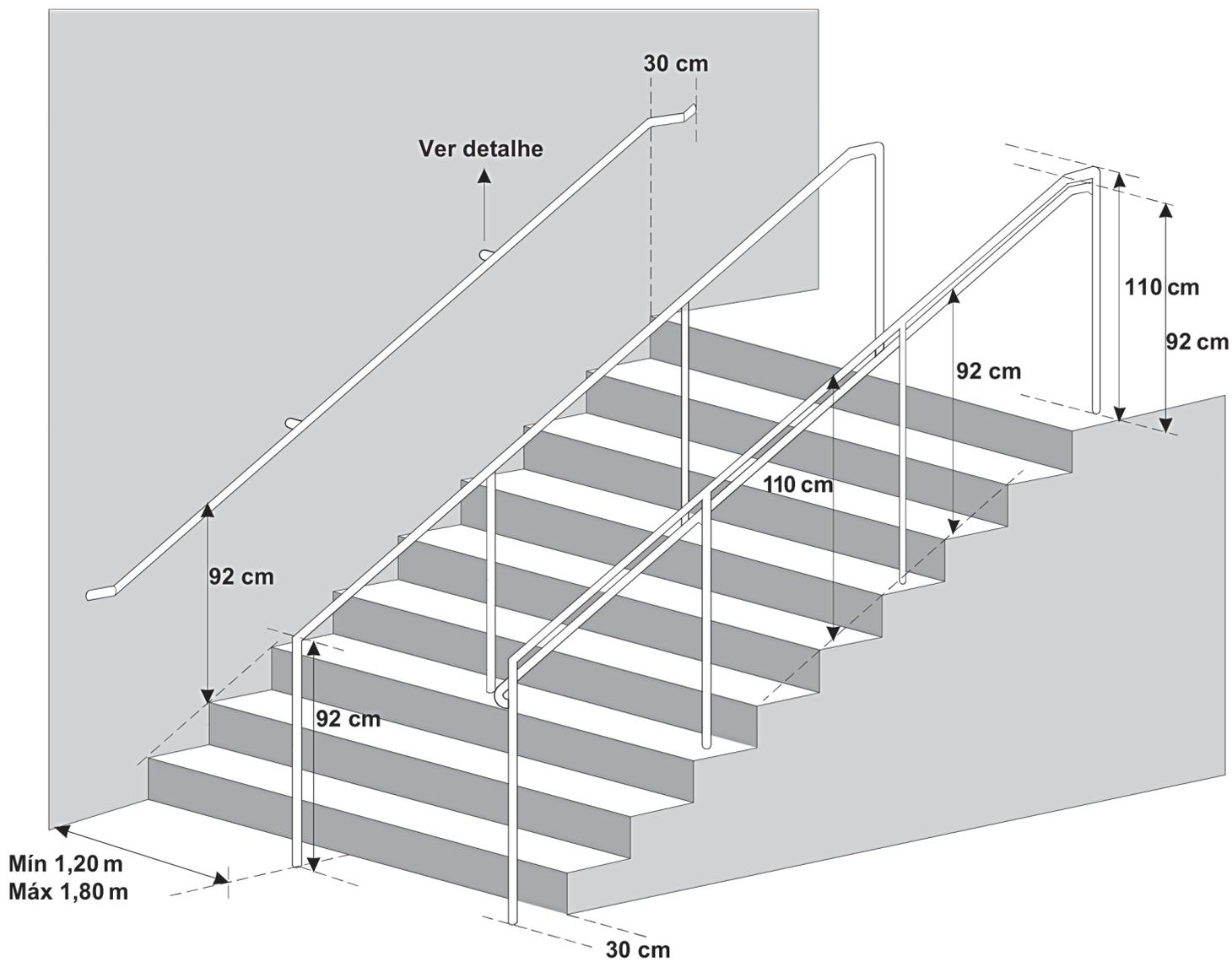
Figura 4: Dimensões dos corrimãos e guarda-corpos das escadas - Fonte: CBPMESP e ARENA, com base no "Green Guide"
