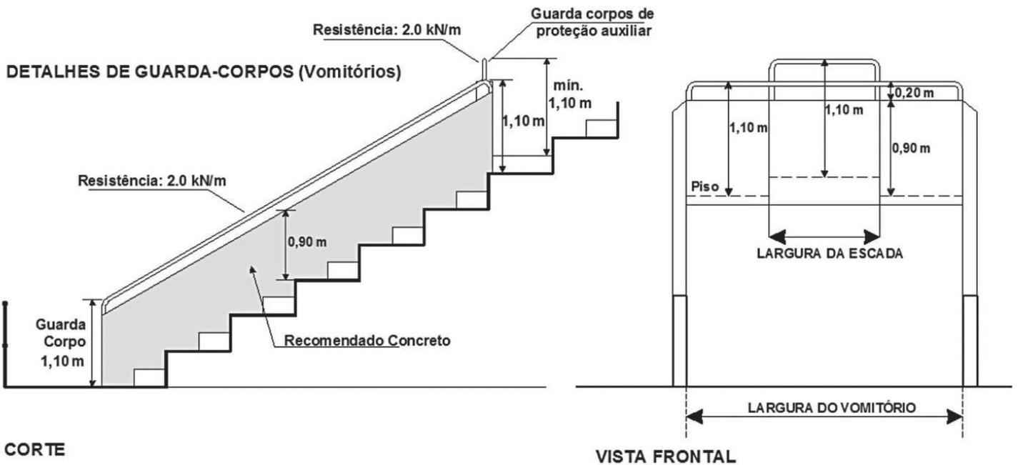
Figura 11: Perspectiva de vomitório padrão - Fonte: CBPMESP e ARENA, com base no "Green Guide"
