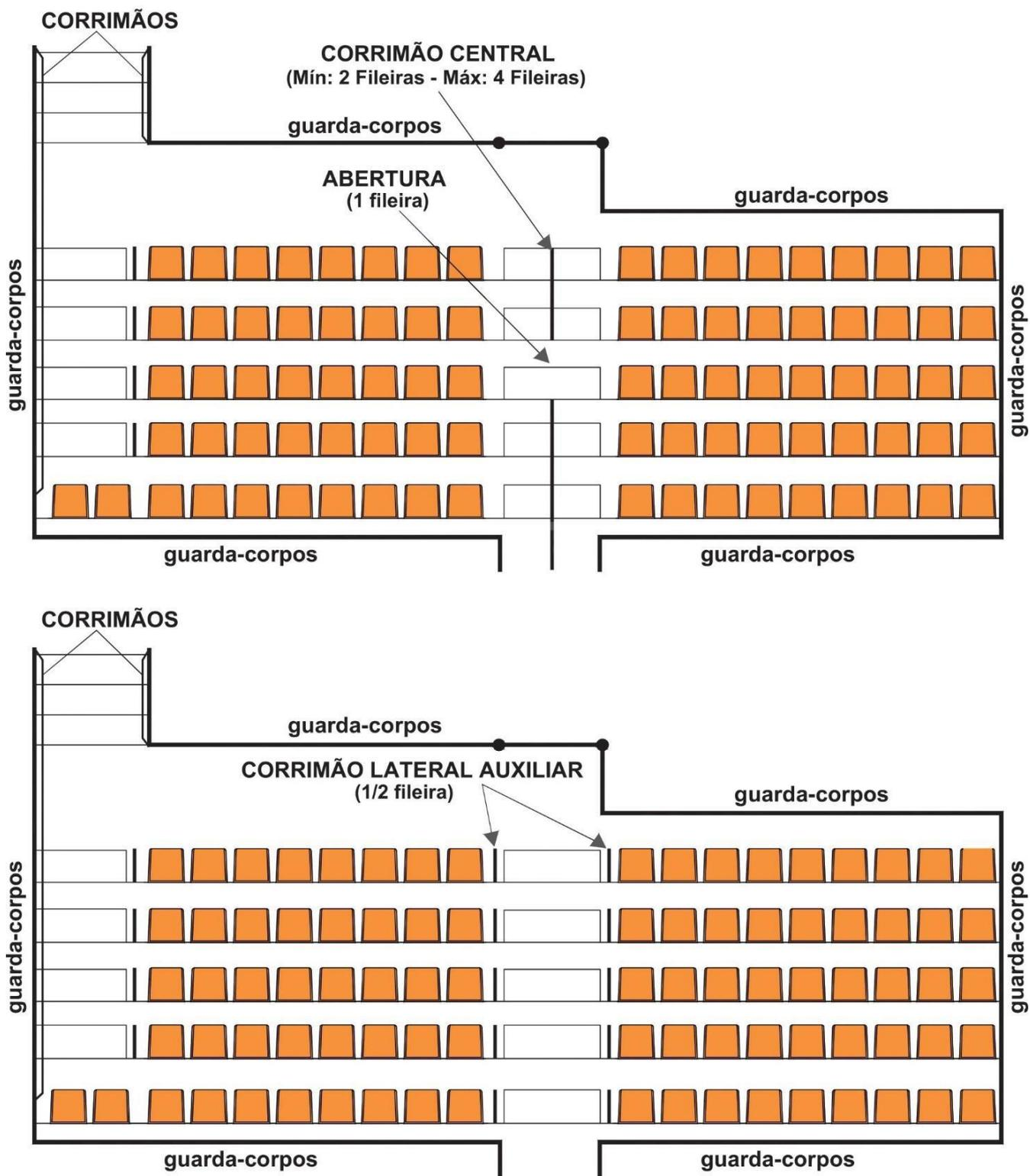
Figura 6: Corrimãos centrais e laterais - Fonte: CBPMESP e ARENA, com base no “Green Guide”
