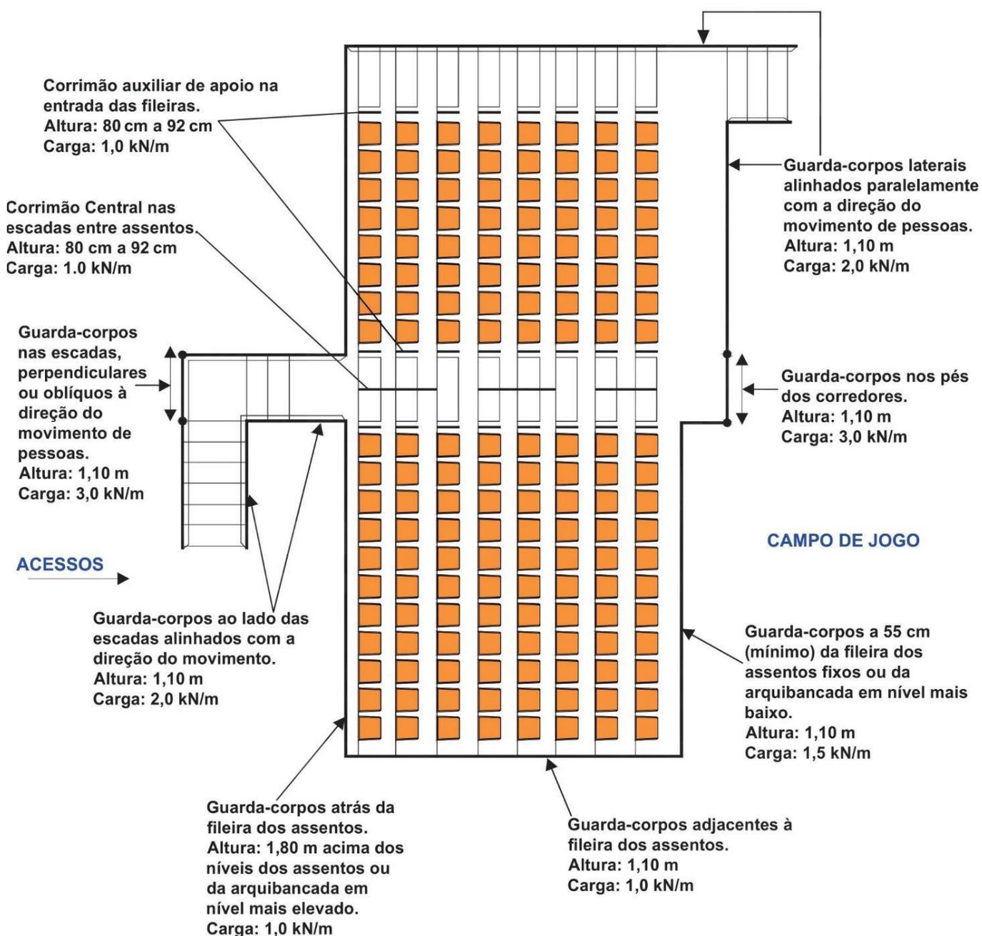
Figura 2: Barreiras, guarda-corpos e corrimãos centrais: cargas de projeto, alturas e disposições - Fonte: CBPMESP e ARENA, com base no "Green Guide"
