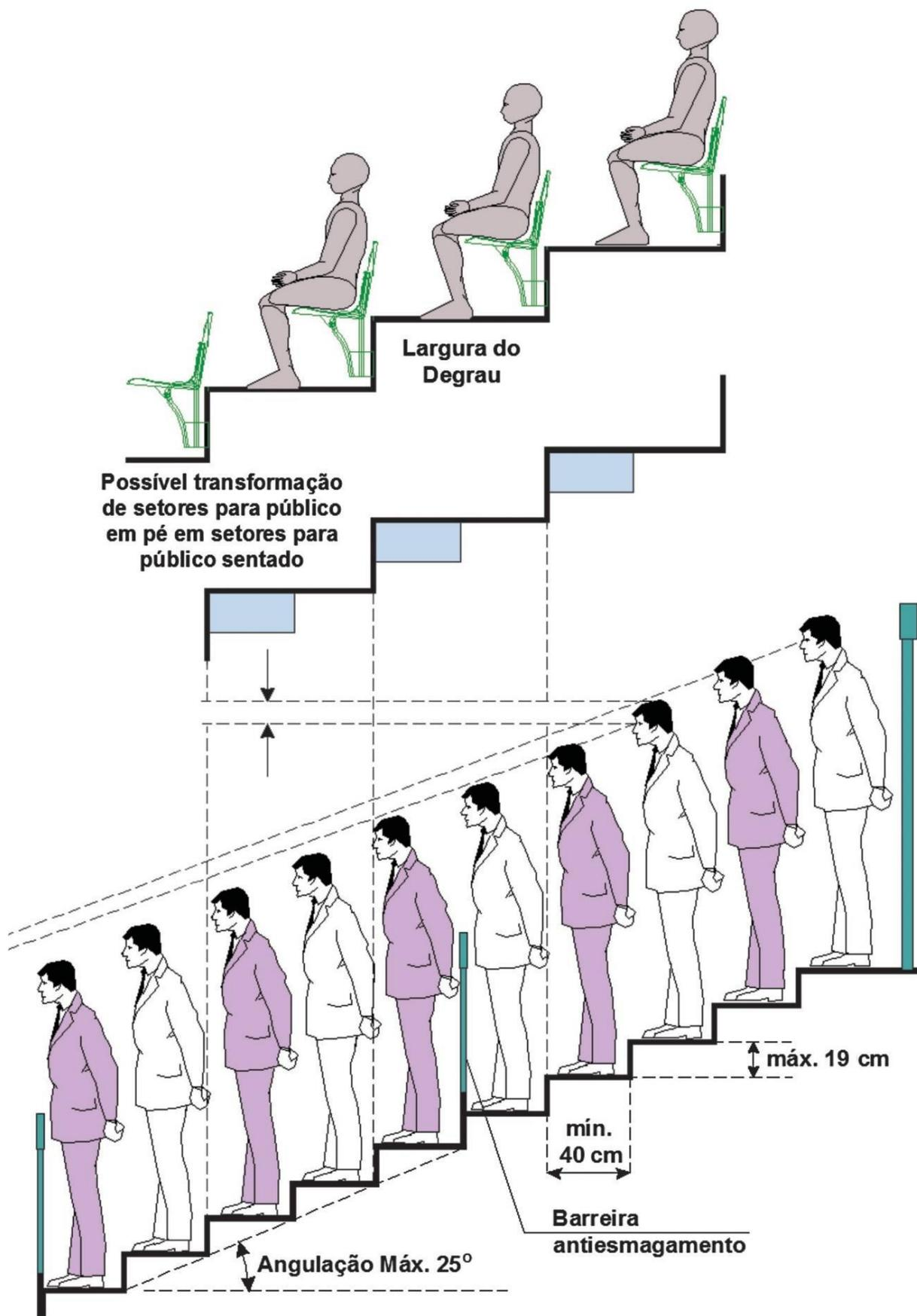
Figura 7: Detalhe de patamares para público em pé - Fonte: CBPMESP e ARENA, com base no "Green Guide"
