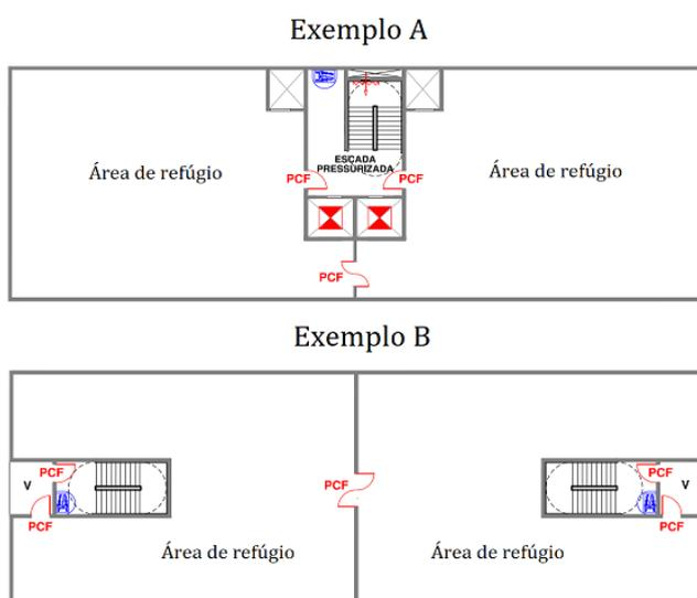
**Figura 25:** Exemplos esquemáticos de áreas de refúgio (ilustrativo).
