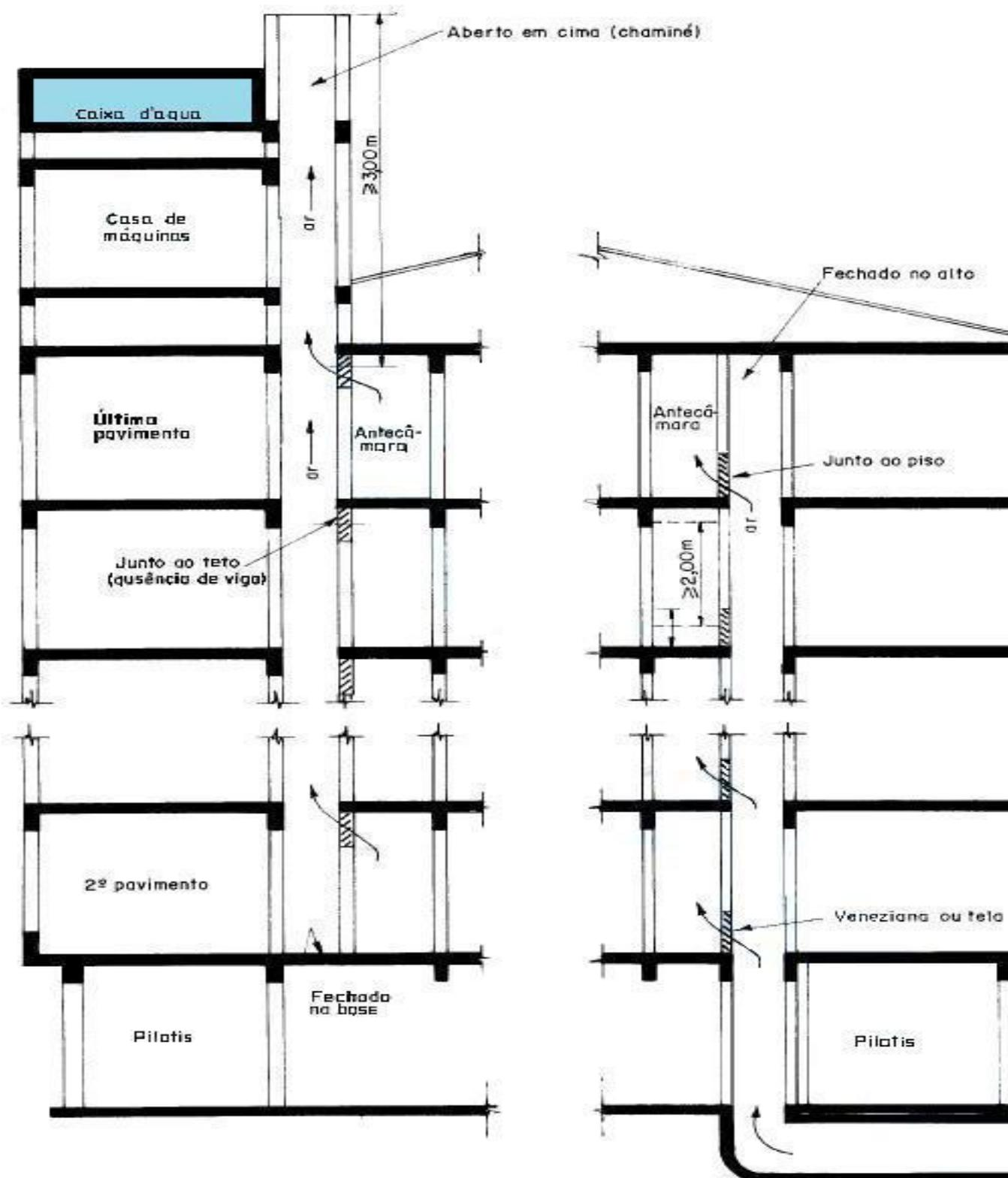
Figura 18: Exemplo de dutos de ventilação (corte AB e corte CD).
