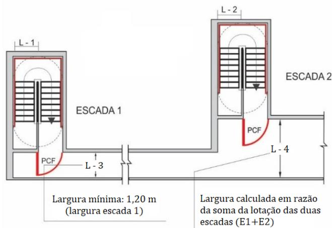
**Figura 26:** Dimensionamento de corredores de descarga
