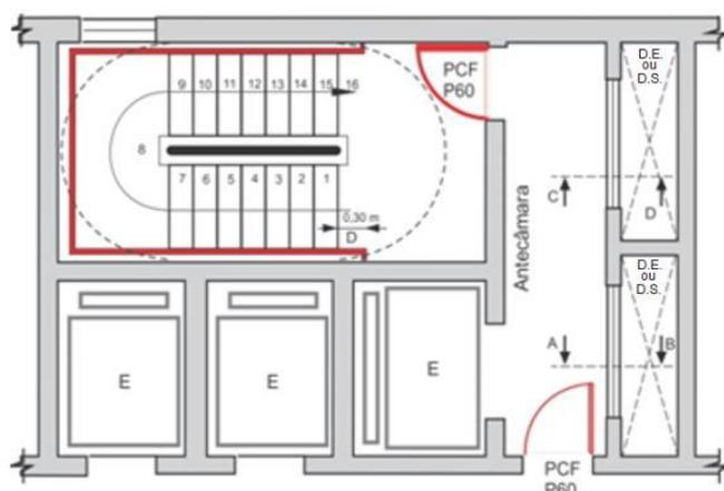
**Figura 17:** Escada enclausurada à prova de fumaça (demonstração dos dutos).
