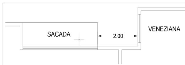
**Figura 11:** Distância entre a veneziana da escada EP e qualquer outro tipo de abertura em planos distintos.
