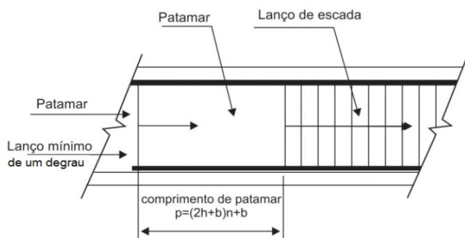
**Figura 5:** Lanço mínimo e comprimento de patamar.
