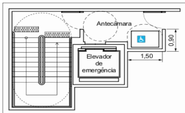
**Figura 16:** Escada enclausurada à prova de fumaça, com área para pessoas com deficiência.
