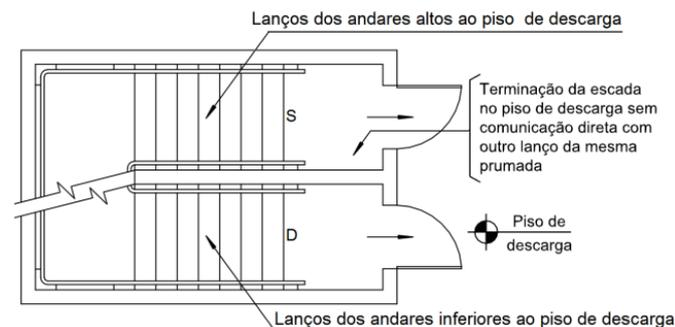
Figura 3: Segmentação das escadas no piso da descarga.
