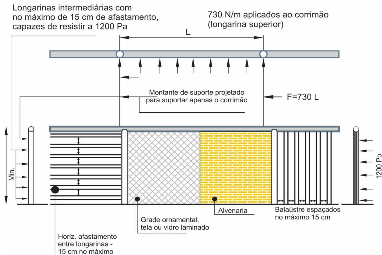
**Figura 24:** Pormenores construtivos da instalação de guardas e as cargas a que elas devem resistir
