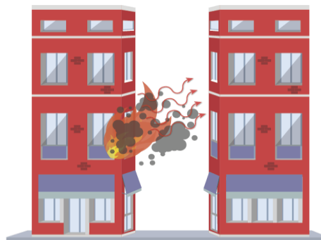
Figura 2: Propagação entre fachadas
