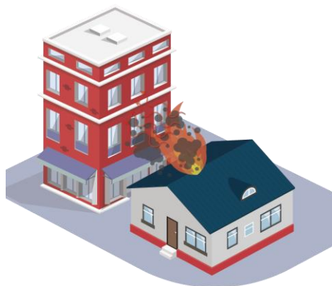
Figura 3: Propagação entre cobertura e fachada.
