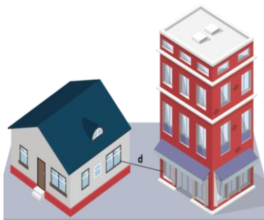
Figura 10: Distância entre fachadas paralelas ou não coincidentes.
